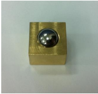
15x15x15 mm Cube + \phi 10 mm Ball
